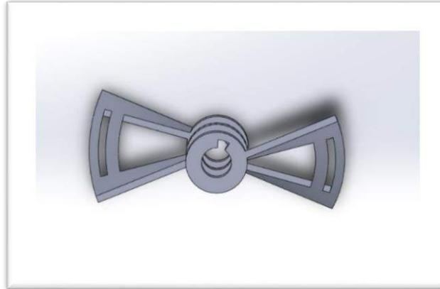
**Figura 6.2.1.4.2 – Forma de las palas de mezclado con chavetero**
