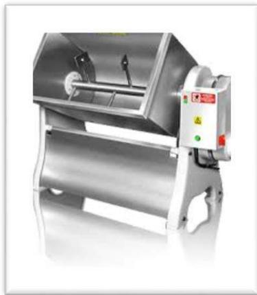
**Figura 3.2.5.1- Amasadora de eje horizontal**
