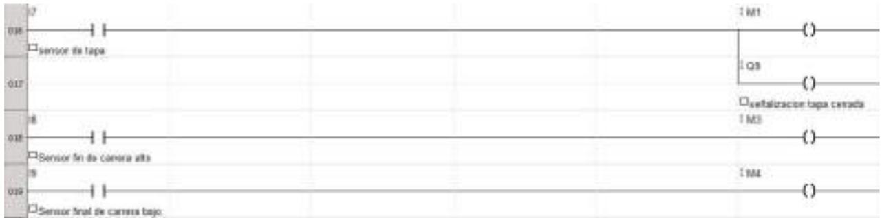
**Figura 11.1 – Programación en ladder del funcionamiento de la amasadora**
