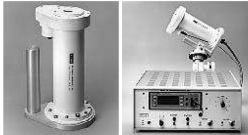
Figura 23: Pirheliómetro Autocalibrable de Cavidad Absoluta Modelo HF.
