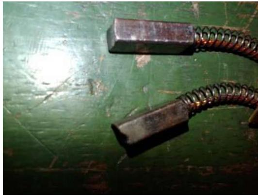
Figura 169: Escobillas en Mal Estado
