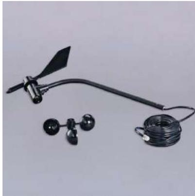
Figura 145: Anemómetro y Veleta de la estación “Weather Monitor II”
