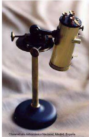
Figura 25: Pirheliómetro Compensado Ångström
