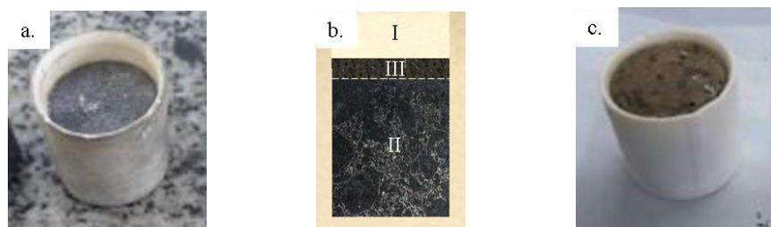
Figura 3.2.7 – Portamuestra para los ensayos protección de refractarios MgO-C con escoria: (a) probeta dentro del crisol de alúmina; (b) corte del conjunto crisol (I) + muestra (II) + escoria (III); (c) vista de la capa de escoria adherida a la muestra refractaria.
