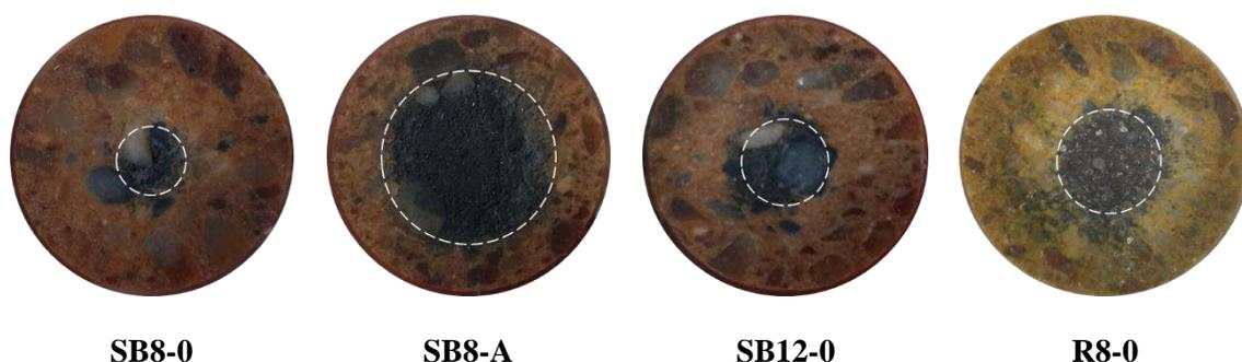
Figura 2.1.12. Corte transversal de las muestras de los ladrillos MgO-C luego del ensayo de oxidación (1400°C).
