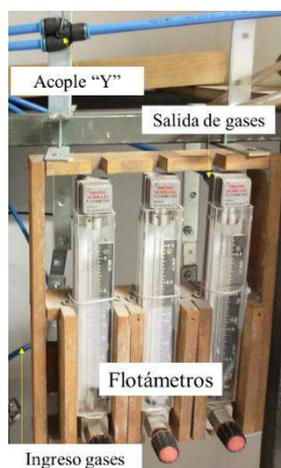
Figura 3.1.7 – Sistema de control del flujo de gases (SG).
