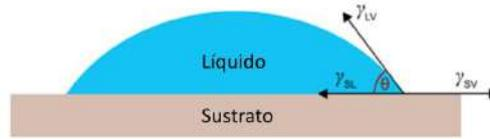
Figura 1.9 – Esquema de una gota de líquido sobre un sustrato sólido (adaptada de Reynaert y Szczerba 2020).
