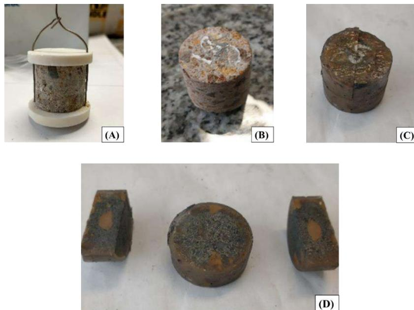
Figura 3.1.9 – Proceso de seccionamiento de una probeta ensayada: luego del ensayo (Ay B) embutida en resina poliéster (C) y seccionada para el análisis de imagen (D).
