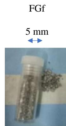
Figura Anexo 2.2.1 – Impurezas metálicas extraídas de la EscFC.
