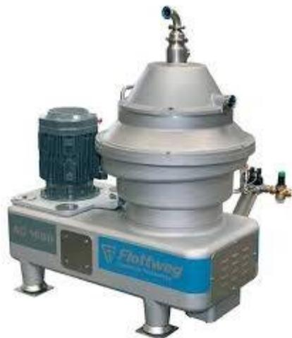
**Figura 5-9.** Centrífuga tipo disco serie AC-1000.
