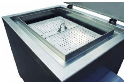
Figura 44. Cestos perforados de 500 litros (Jumainox, 2020).
