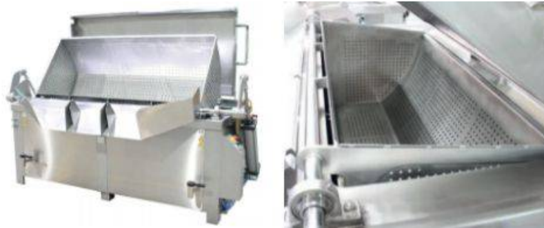
Figura 42. Batea con cesto basculante para el remojo (Jumainox, citado 26 de septiembre 2020).
