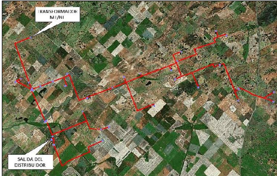
Figura 3.3.1 - Distribuidor rural de media tensión de la Coop. de Electricidad Gral. Balcarce Ltda.
