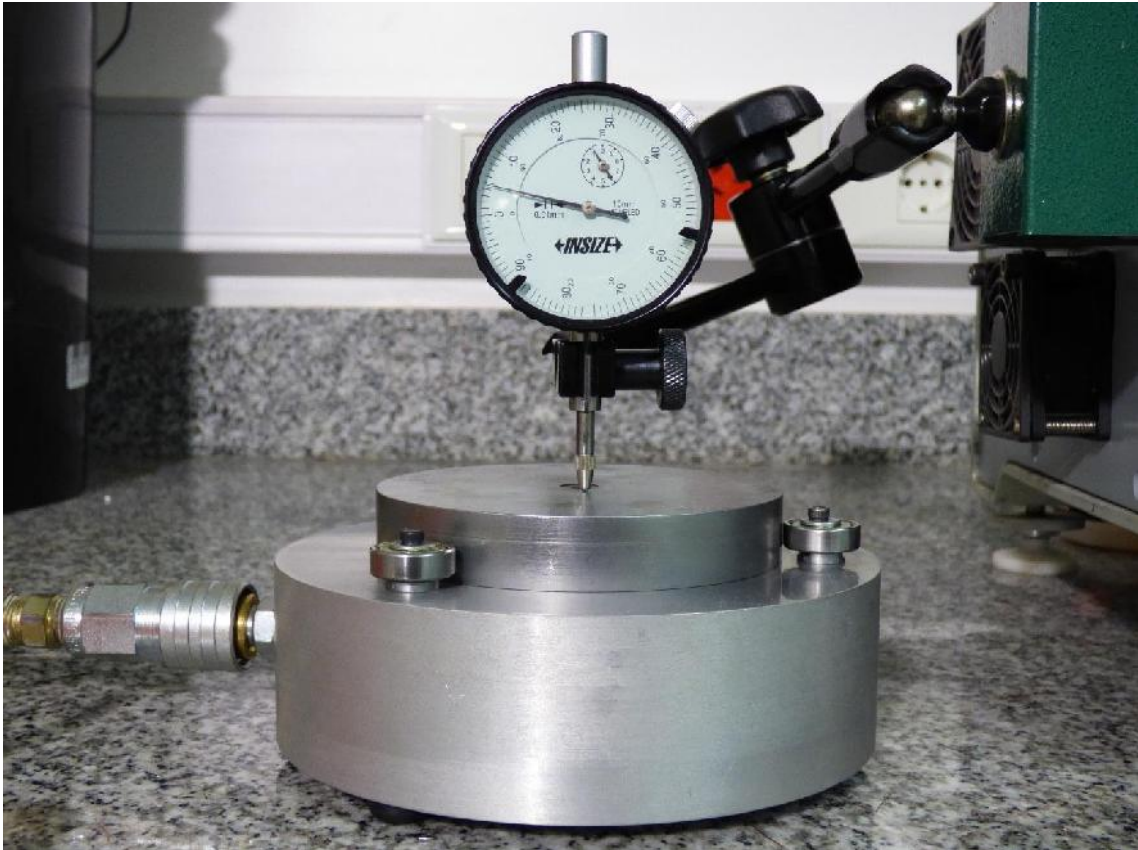
Figura 60. Medición de espesores de película generada para distintas presiones de alimentación, mediante un reloj comparador. En este caso, con el cojinete descargado.
