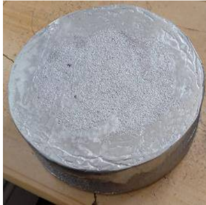
Figura 55. Tocho de aluminio colado en molde de arena, para el mecanizado de la base del cojinete. Diámetro 150 mm.
