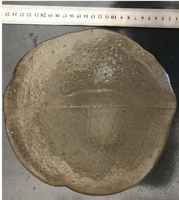
Figura 33. Diámetro de extendido de la dosificación MACO.
