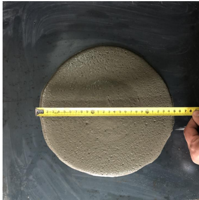
Figura 37. Ensayo de diámetro de extendido para la dosificación MAC20.
