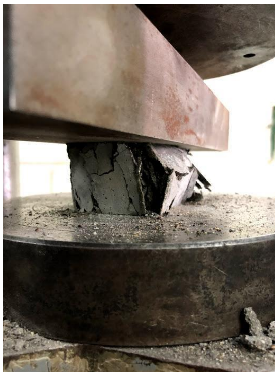
Figura 60. Abarrilamiento en probeta con fibra.
