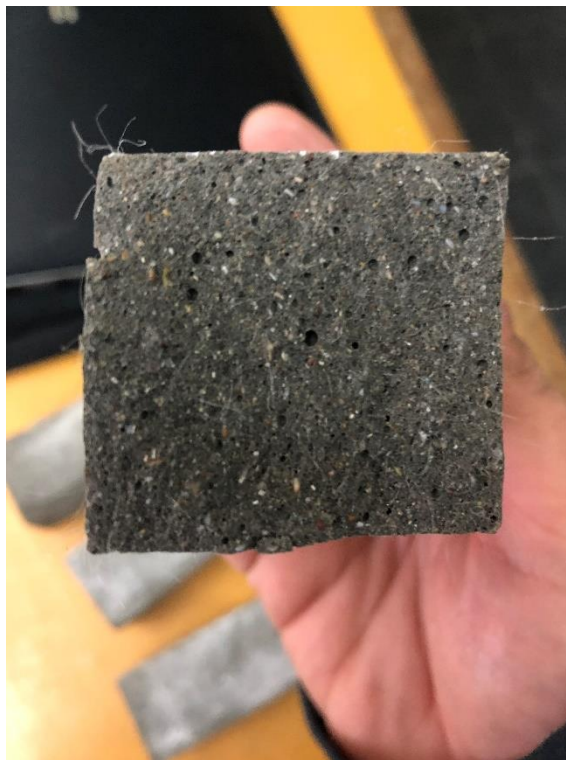
Figura 56. Superficie de fractura de probeta preparada con la dosificación MAC20F.
