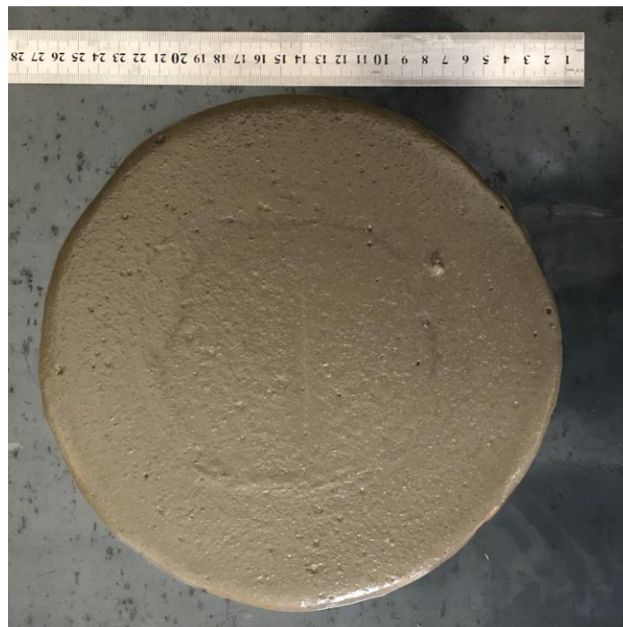
Figura 36. Ensayo de cono de la dosificación MAC10.
