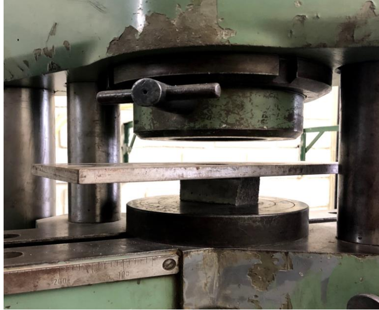
Figura 13. Probeta posicionada para el ensayo a compresión.
