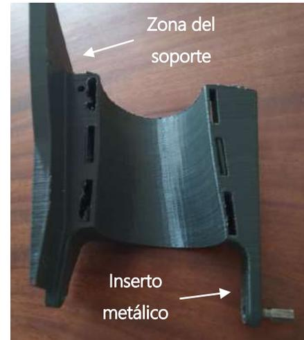
**Figura 4.21.** Brazo con el inserto metálico
