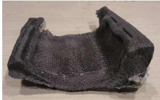
**Figura 6.8.** Buen copiado de la geometría, pero deformación del núcleo a raíz de la alta temperatura.
