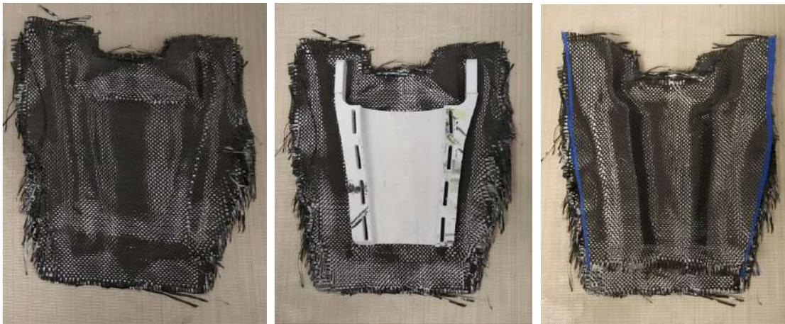
Figura 6.2. Etapa de preformado sobre la pieza del antebrazo
