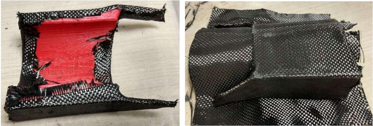
Figura 6.7. Preformado sobre la media caña del brazo
