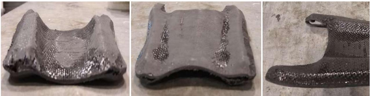
**Figura 6.5.** Pieza del antebrazo laminada, que corresponde a la unión de las piezas 8, 9 y 10.
