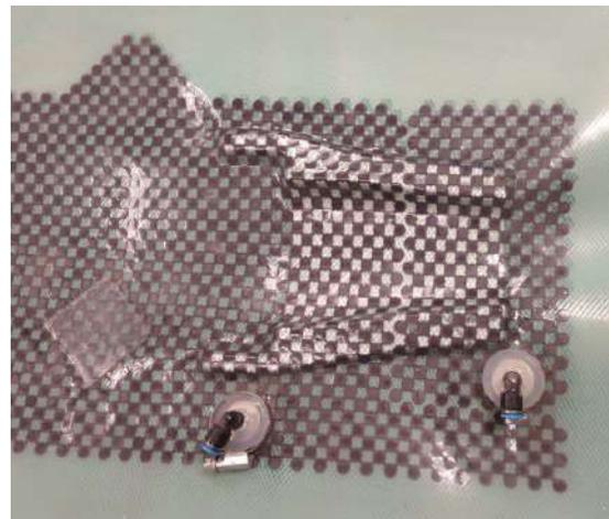
**Figura 6.1.** Pieza del antebrazo en el equipo de infusión con aplicación de vacío
