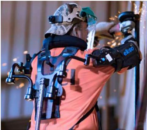
Figura 1.8. Ekso Works con de fibra de carbono
