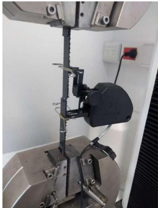
Figura 3.16. Ensayo de tracción
