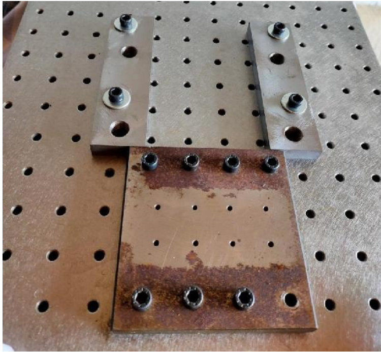
Figura 72. Soportes inferiores y adaptador montados sobre el breadboard.
