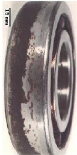
Figura 1. Aspecto de pista exterior de rodamiento desgastado por fretting. [i]
