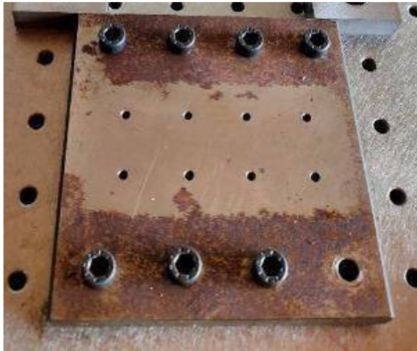
Figura 68. Acople necesario para poder montar el microactuador sobre el breadboard.
