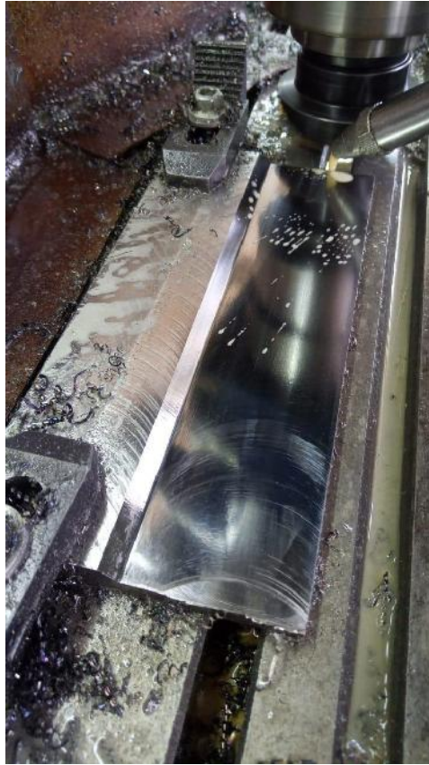
Figura 48. Fresado sobre planchuela de Acero SAE 4140 utilizado para conformar el cantilever
