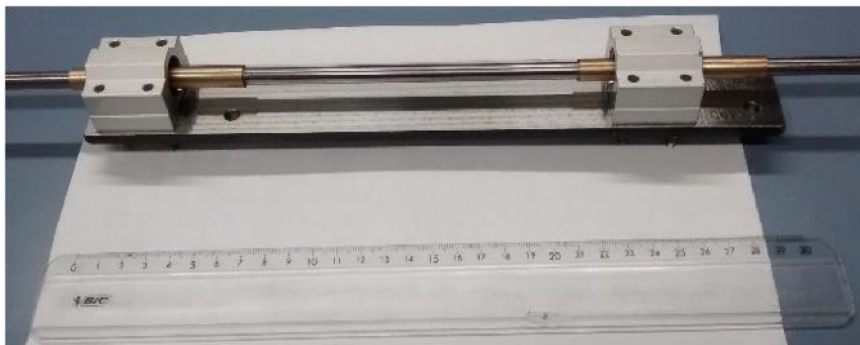
Figura 15. A) Conjunto varilla rodamiento. B) Guía de rodamientos lineales Bosch Rexroth. [vii]
