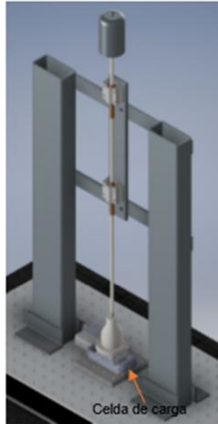
Figura 26. Esquema de la máquina a analizar y rediseñar. Se señala la ubicación potencial de la celda de carga [vii]
