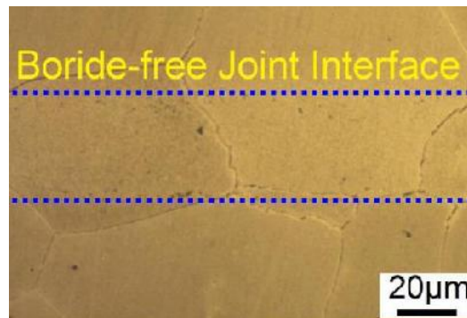
Figura 7.2. Unión IN718/ BNi-2/IN718 libre de boruros en la DAZ con un tratamiento térmico post-soldadura de 12 h a 1150°C y dos etapas de envejecimiento a 760°C durante 10h y 650°C durante 6h (Pouranvari, 2017).
