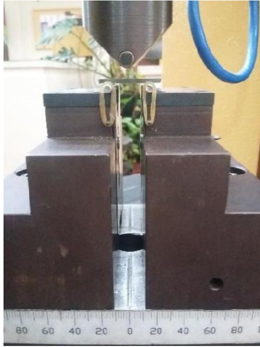
Figura 5.9. Configuración del ensayo de flexión en 3 puntos.
