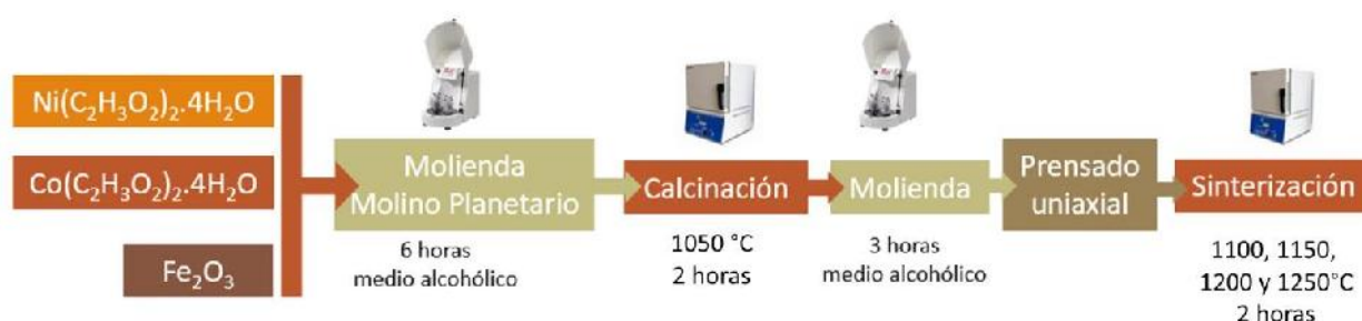
Figura 2.3. Diagrama de flujo de la metodología experimental empleadas para la obtención de cerámicos de composición NCF por reacción en estado solido
