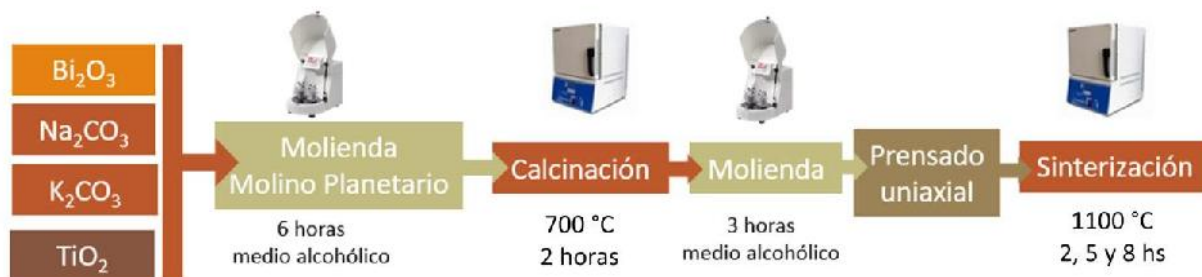
Figura 2.2. Diagrama de flujo de la metodología experimental empleadas para la obtención de cerámicos de BNKT por reacción en estado solido
