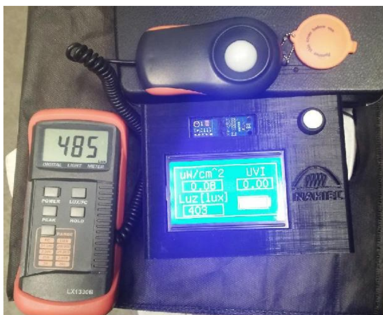
Figura 59: Comparativa del luxómetro con el LX1330B utilizando el vidrio protector
