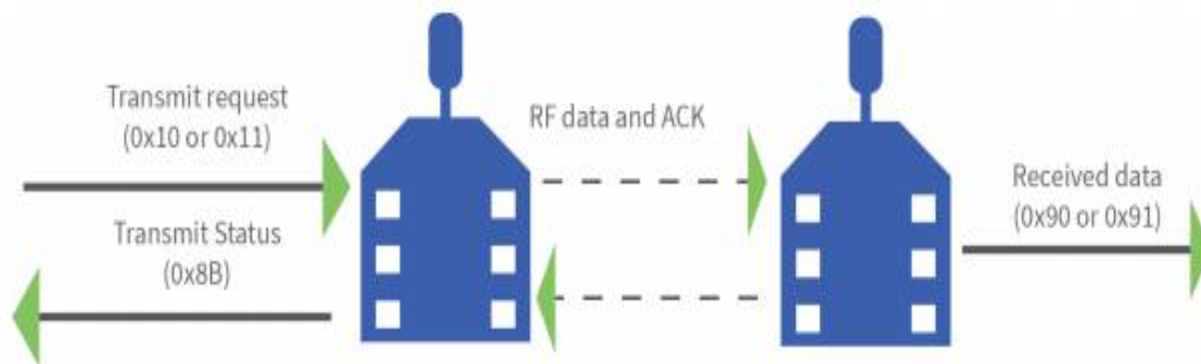
Figura 108: Comunicación general de módulos Xbee entre ellos y con un microcontrolador. Extraído de “ Xbee/Xbee-PRO Zigbee RF Modules User Guide ”, por DIGI International.2018. Copyright 2018.
