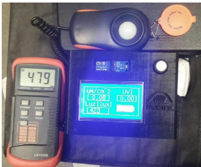
Figura 58: Comparativa del luxómetro con el LX1330B sin utilizar el vidrio.
