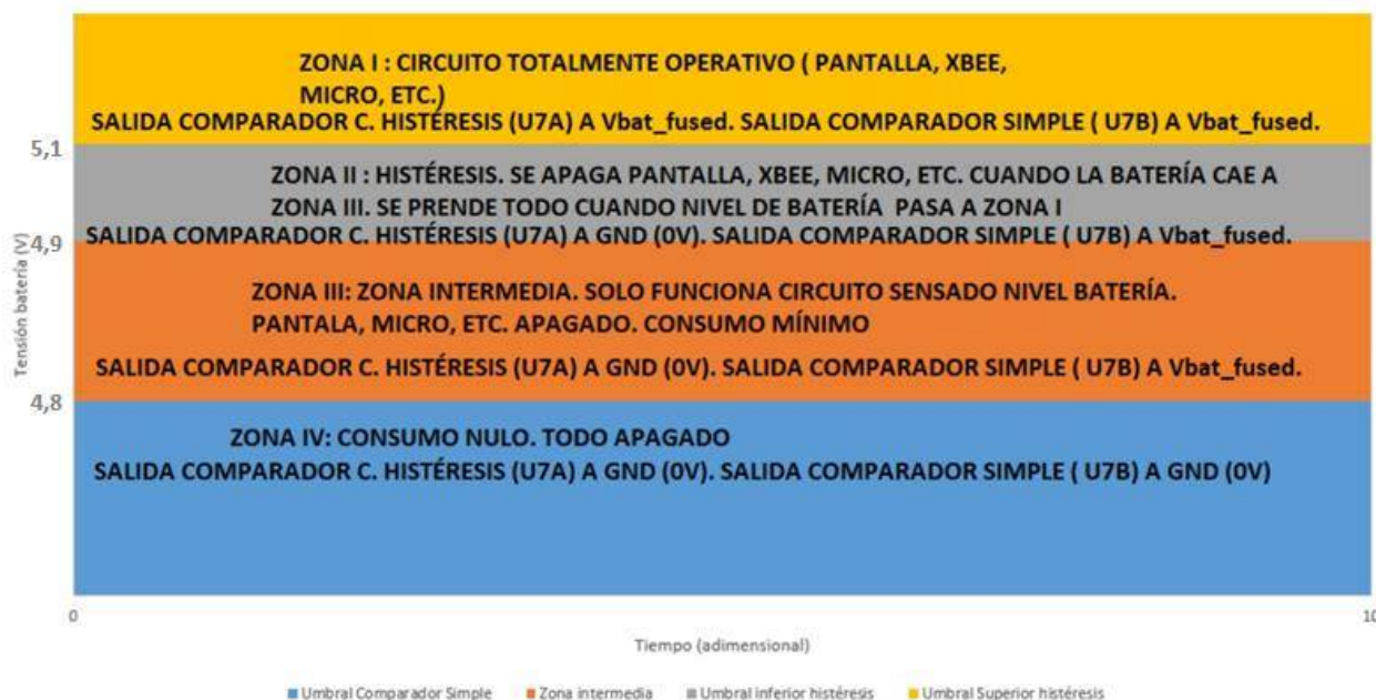
Figura 125: Circuito de control de tensión de batería dividido en cuatro zonas con valores de corte modificados.
