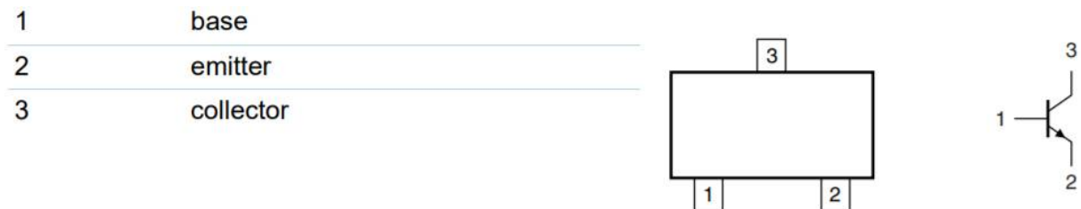
Figura 117: Conexionado de BC848B.
