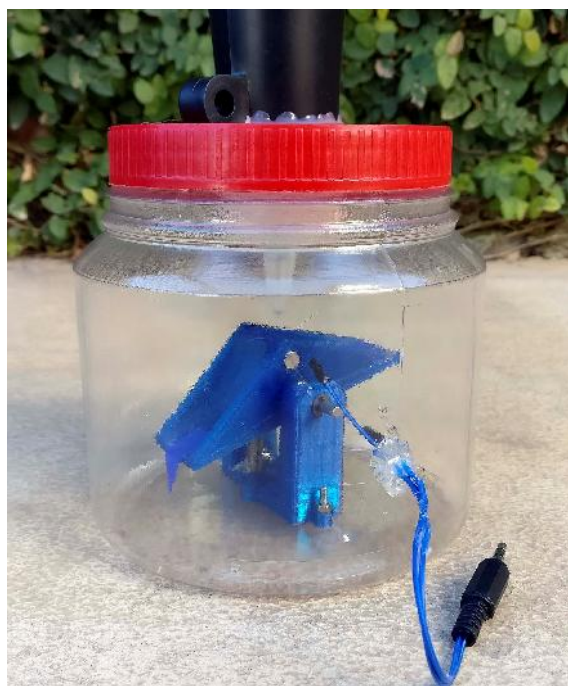
Figura 2.21: Vista de cubeta basculante en contenedor
