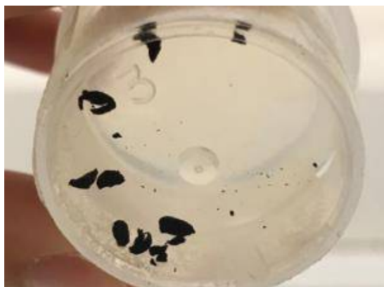
Figura 18. Disolución parcial y ruptura de las perlas P2-C0 durante el ensayo de hinchamiento.
