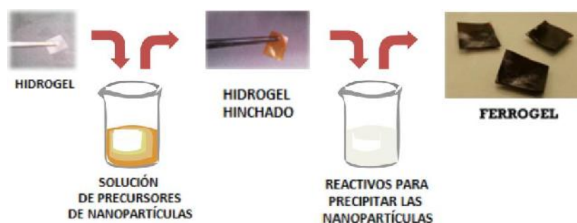
Figura 6. Preparación de un ferrogel mediante el método de precipitación in-situ .
