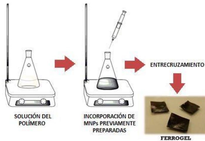
Figura 5. Preparación de un ferrogel mediante el método de gelación in-situ .
