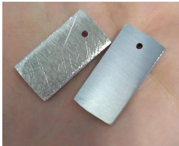
Figura 3.2 - Muestra as received (izq.) y muestra luego del pulido (der.)
