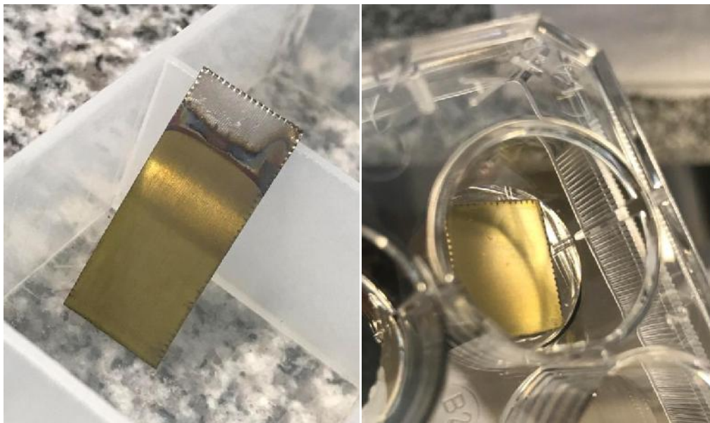
Figura 3.3 – Muestras de Zr 702 anodizadas a 60 V
