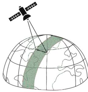
Fig. 6.4: Franja o ventana de observación de un sensor.
