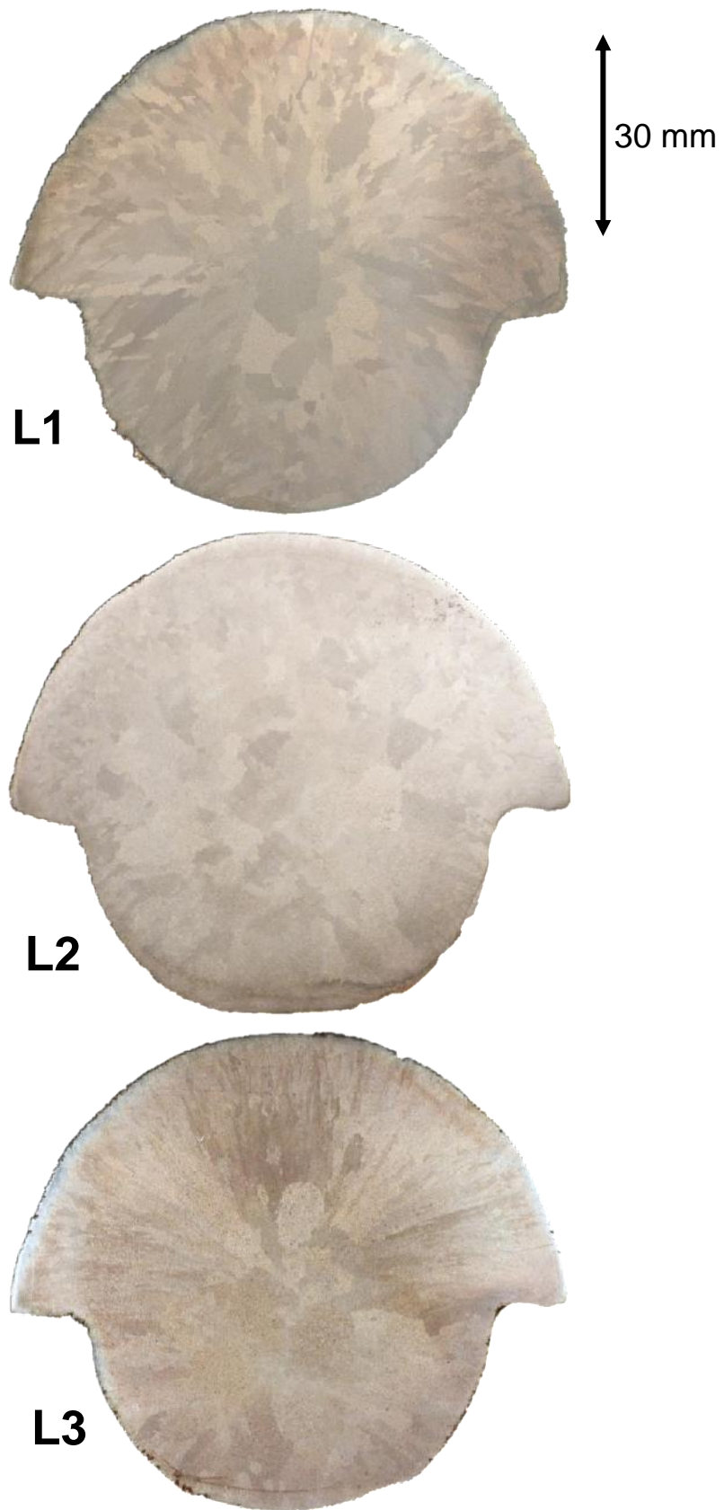
Figura 3.3: Macroestructuras de solidificación de las muestras de las coladas L1, L2 y L3.
