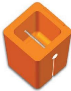
Figura 2.8: Copa de análisis térmico empleada para registrar la curva de enfriamiento de manera experimental. Sus dimensiones son de 50 x 50 x 65 mm.
