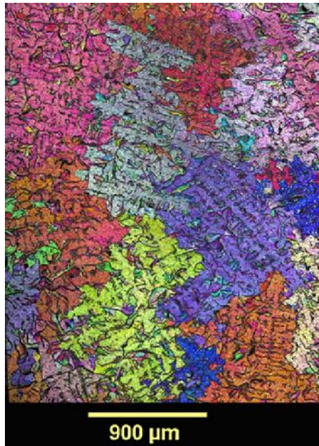
Figura 1.18: Mapa EBSD obtenido para una muestra de fundición laminar previamente sometida a la técnica DAAS [55].
