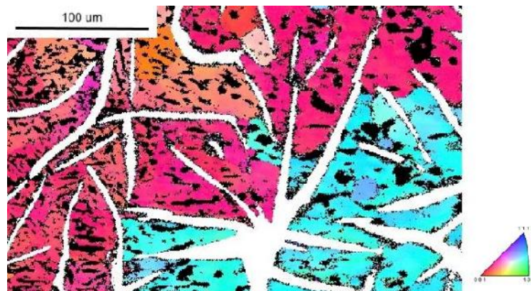
Figura 3.12: Mapa de orientación cristalina correspondiente a la muestra de la colada L2 que presenta una unidad de grafito laminar en contacto con dos granos de austenita diferentes.
