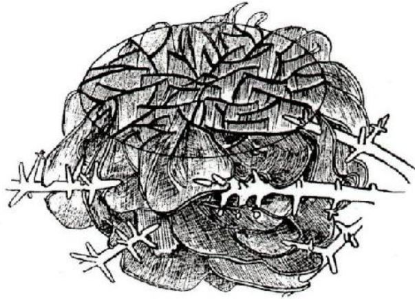
Figura 1.22: Esquema de una colonia de grafito laminar interactuando con dendritas de austenita, Morrogh y Oldfield (1959) [64].
