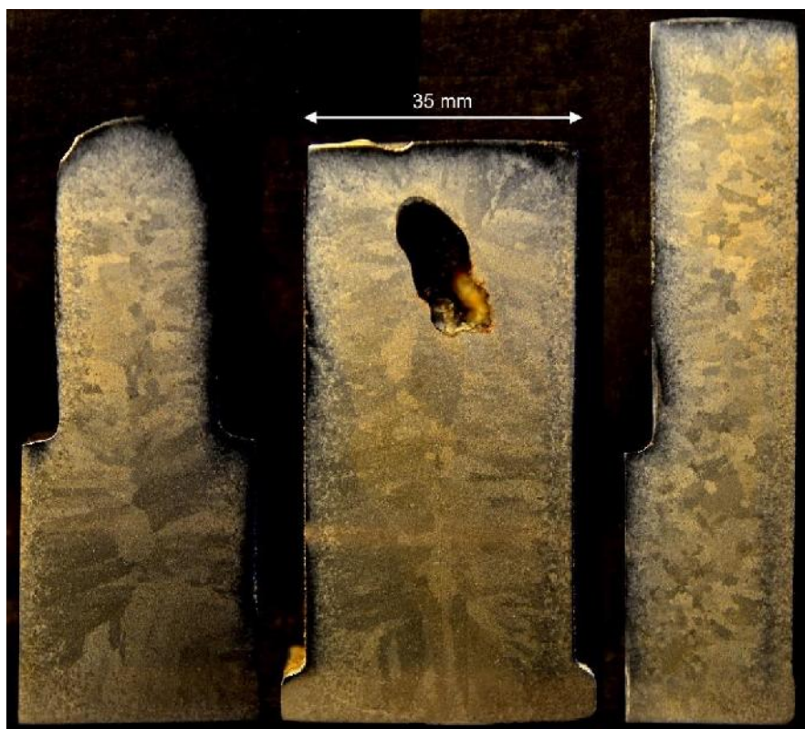
Figura 4.5: Macroestructura de solidificación de las muestras de la colada V2.
