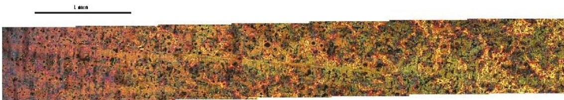
Figura 4.6: Microestructura de muestra de la colada V2 luego del ataque con reactivo color.
