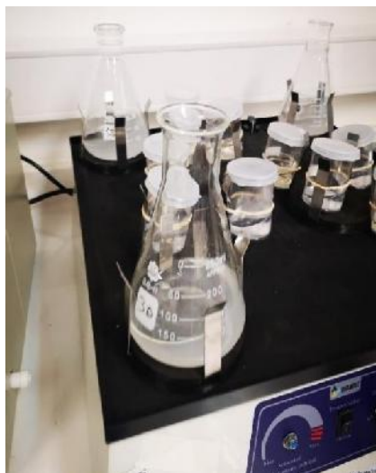
Figura 28: Sistema en batch para el análisis de remoción con HT.
