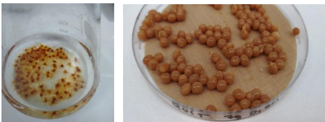
Figura 51: A la izquierda se observan perlas que perdieron su resistencia durante el proceso de entrecruzamiento en NaOH (QTE4). A la derecha, perlas QTE5 durante el secado.
