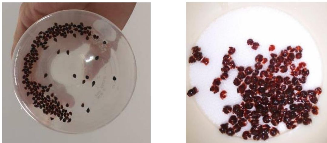
Figura 54: Esferas de QTE5 antes de los ensayos de remoción y luego de su 1er reuso (se observa la rotura de las perlas).
