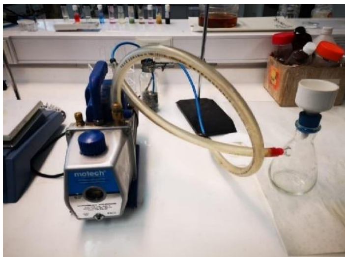
Figura 29: Sistema de filtración para la obtención de las muestras a medir.
