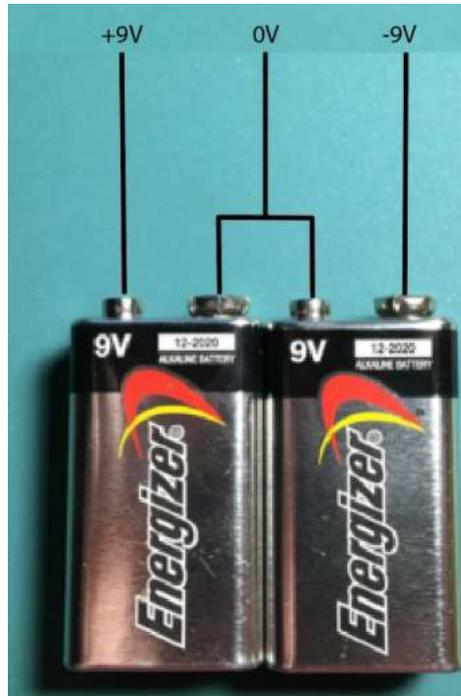
Figura 3.20 Diagrama de conexión de baterías de alimentación
