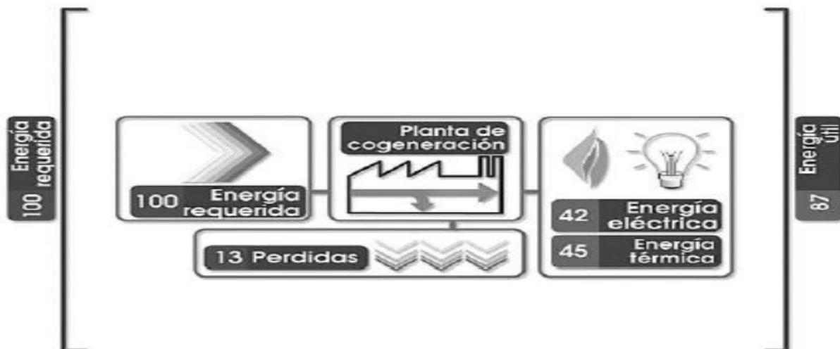
Figura 2.1.2: Sistema típico de cogeneración. Fuente: [1]
