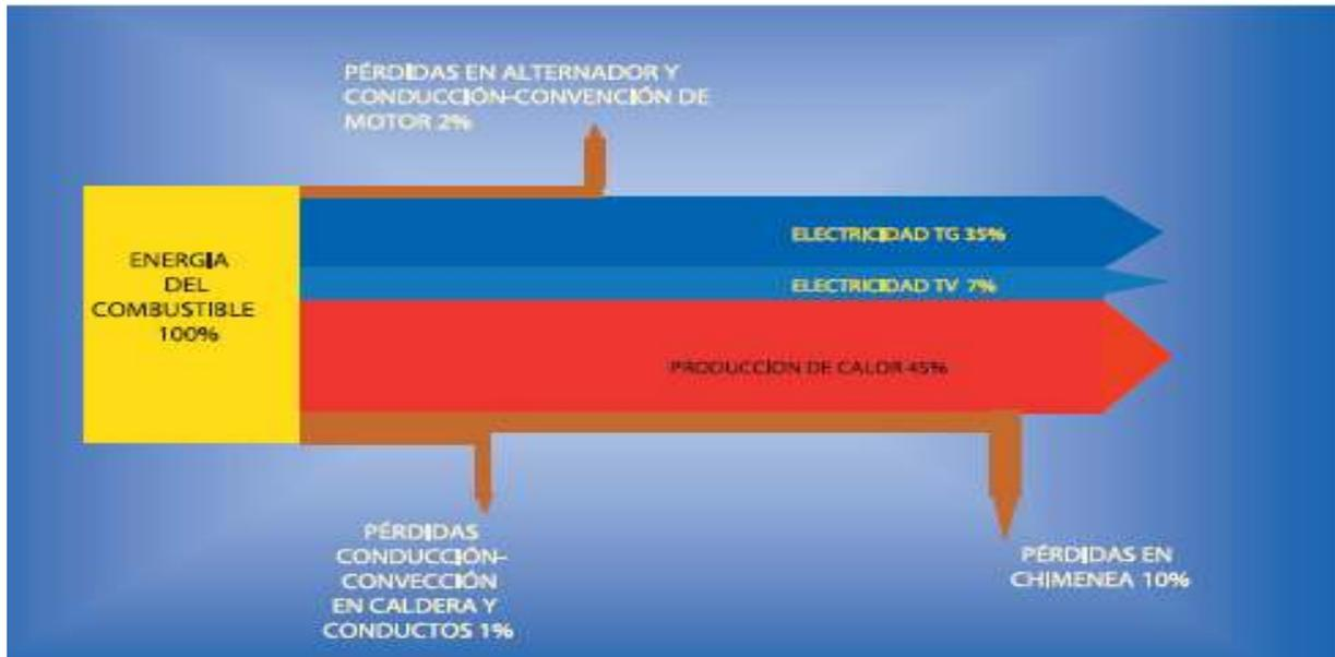
Figura 3.5.1: Diagrama de Sankey de Planta de cogeneración en ciclo combinado con turbina de gas. Fuente: [9].
