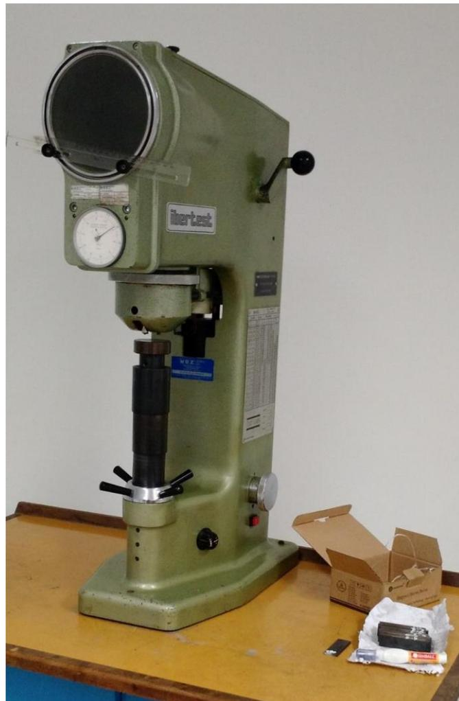
Figura 4.10 Durómetro
