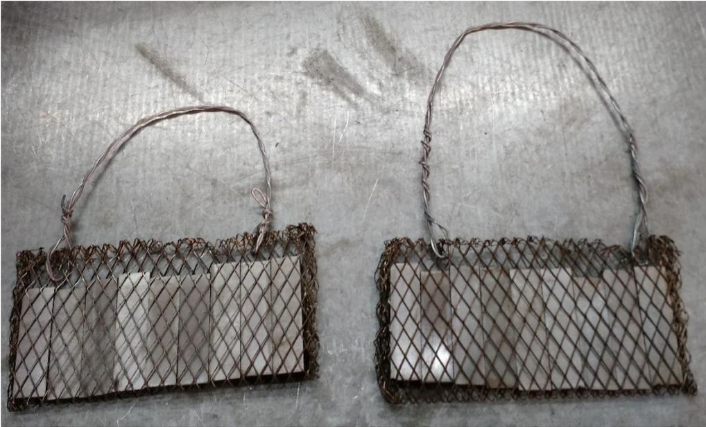
Figura 4.3: Preparado de probetas para el tratamiento térmico
