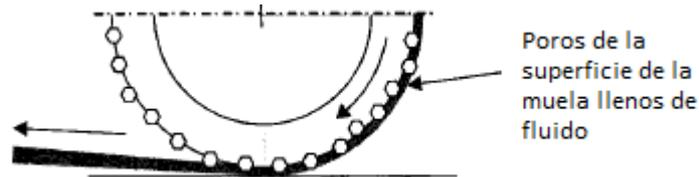
Figura 2.8.1. Efecto de bombeo que generan los poros de la superficie.
