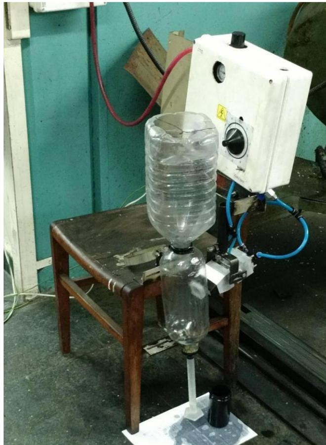
Figura 5.10: Prototipo del banco de pruebas
