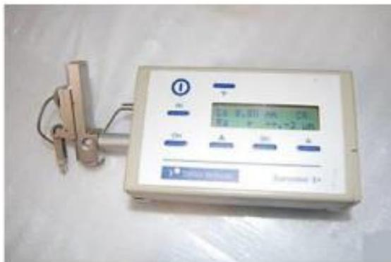
Figura 4.11: Perfilómetro de contacto Taylor-Hubson
