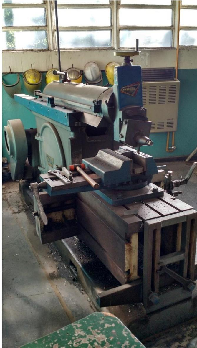
Figura 4.1: Desbaste de probetas en limadora
