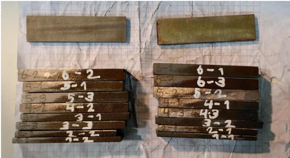
Figura 4.2: Probetas seccionadas de bloque Y, antes del mecanizado.
