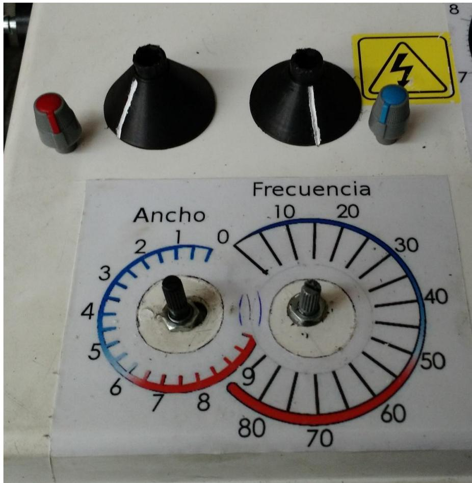
Figura 5.4: Potenciómetros con sus correspondientes escalas y perillas
