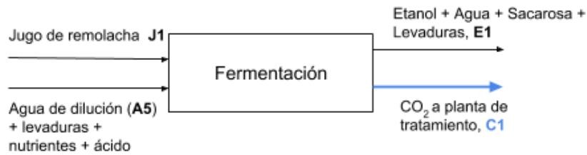
Figura 4.3: Esquema del equipo de fermentación.
