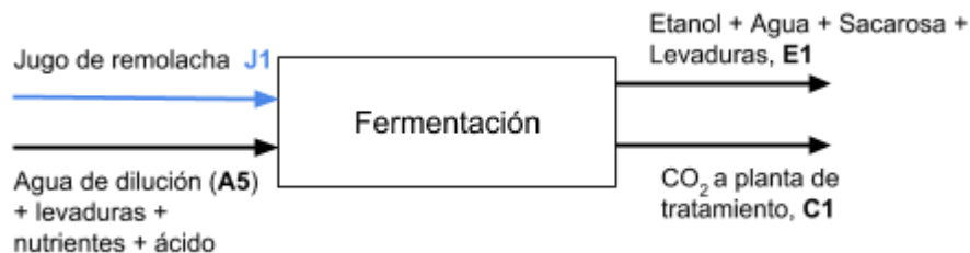
Figura 4.3: Diagrama de bloques de la etapa de fermentación.
