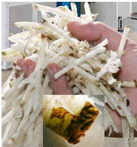
Figura 7.3. Cosetas de remolacha a la salida del molturador
