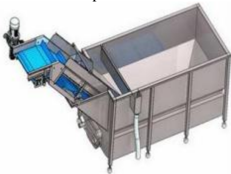
Figura 3.1: tanque de lavado
