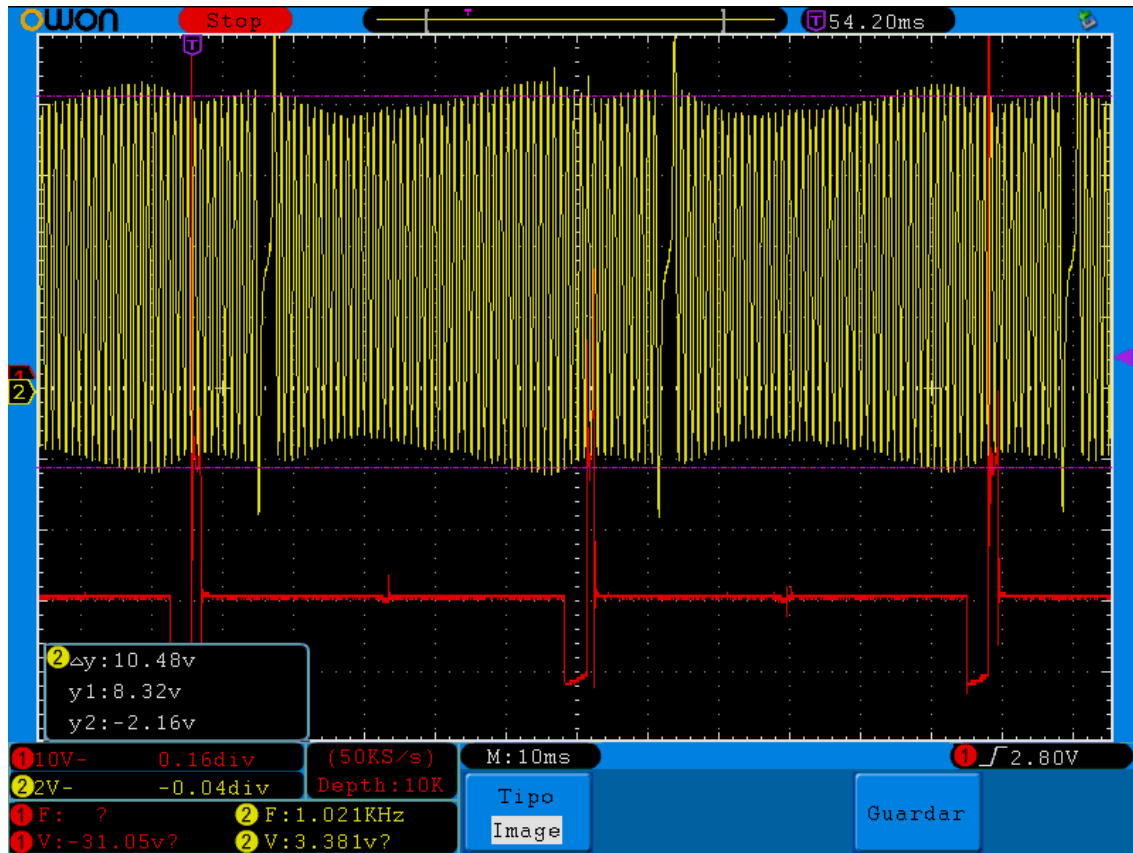
Figura 8.2: Señal del sensor de revoluciones durante marcha regular (traza amarilla).
