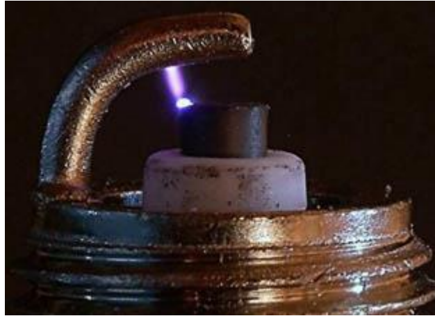
Figura 3.10: Chispa ocurrida en el electrodo de una bujía.
