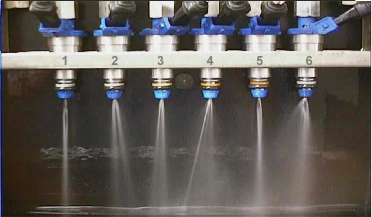
Figura 3.9: Inyectores montados sobre una rampa de inyección.
