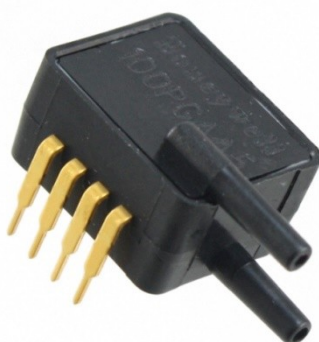
Figura 14. Sensor de presión Honeywell . El sensor devuelve una tensión proporcional a la diferencia de presión existente entre los dos conductos de entrada de aire. Otros modelos de sensores similares tienen un solo conector para medir presión siempre relativa a la atmosférica, pero en este caso se utilizó esta versión más genérica.
