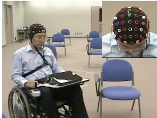
Figura 1.5: Control de una silla de ruedas mediante ondas cerebrales diseñado por Toyota.
