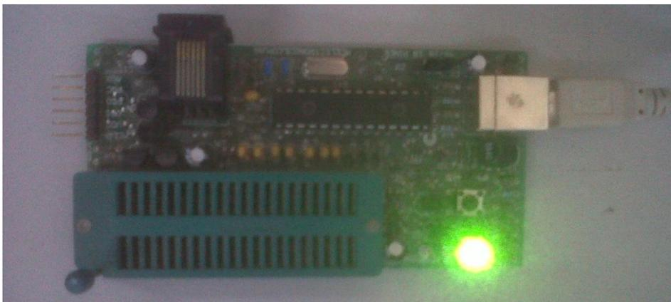
Figura 25 - Programador de microcontroladores PICkit 2
