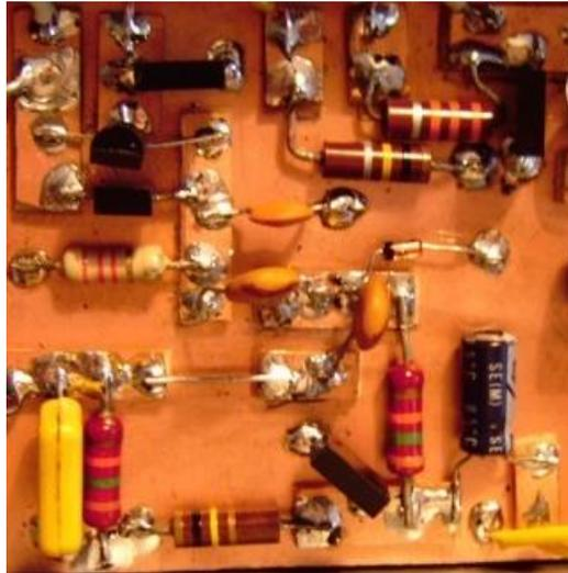
Figura 24A. Fotografía de un circuito con método Manhattan.
