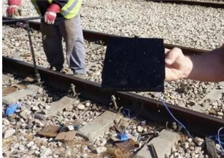
*Ilustración 86: Elemento piezoeléctrico para vías férreas [48]*
