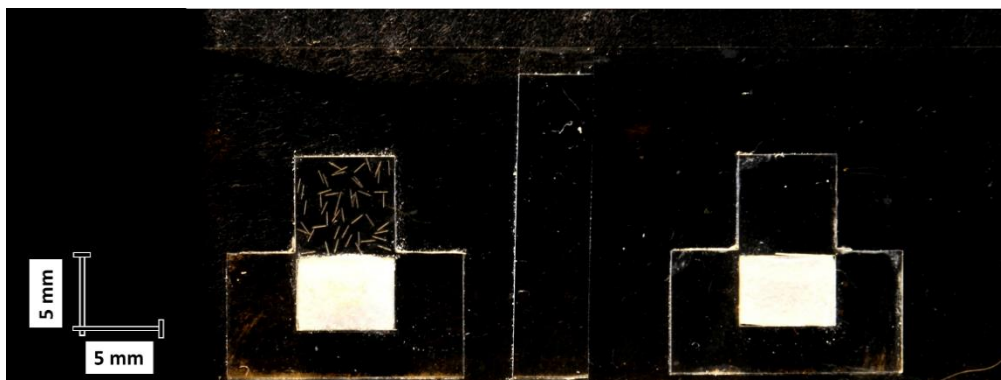
Figura 5.10. Imágenes de una muestra tallada ya cargada con ODOL correspondiente a difusión en medio finito. (a) Fotografía tomada desde un cierto ángulo. (b) Fotografía tomada a 90°.
