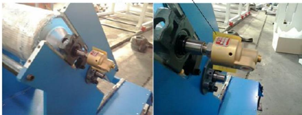
Figura 18. Detalle de juntas rotatorias para circulación de agua de refrigeración.
