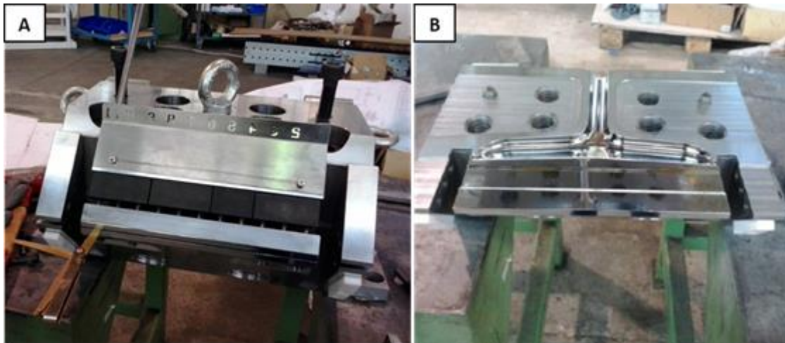
Figura 16. Cabezal utilizado para generar la lámina continua en la salida de la extrusora. Vista exterior (A) e interior (B).
