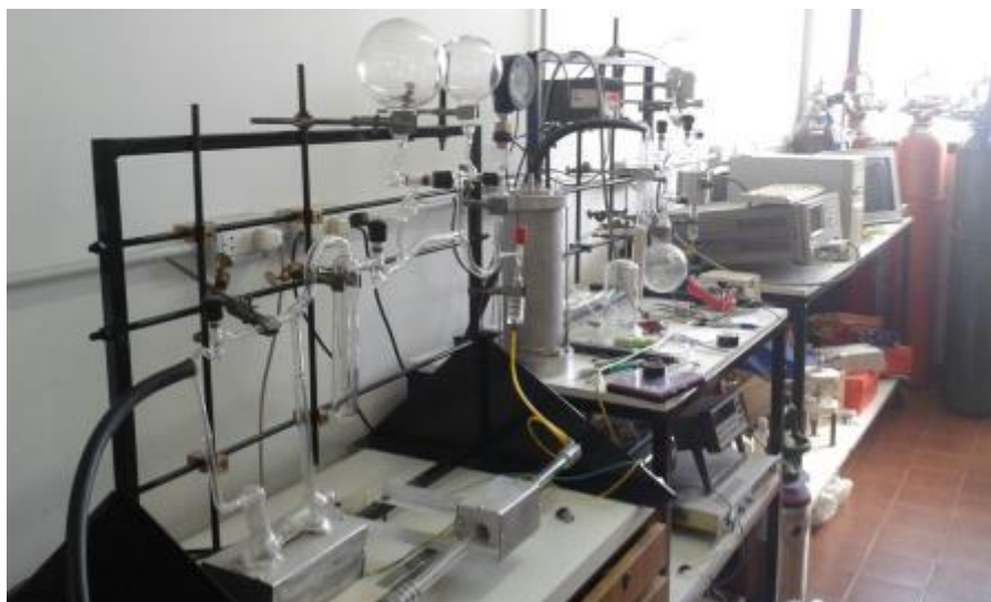
Figura 4.2 Fotografía del equipo utilizado para las medidas eléctricas.
