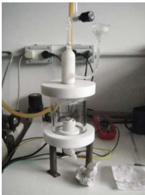
Figura 2.8 Cámara de spray/calcinación donde se muestra modificación en la zona de alimentación
