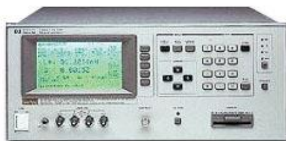
Figura 4.3 Fotografía del impedancímetro usado para las medidas eléctricas R vs t.
