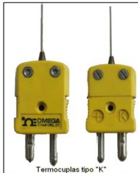
Figura 2.3 Foto de conectores de las termocuplas tipo "K".
