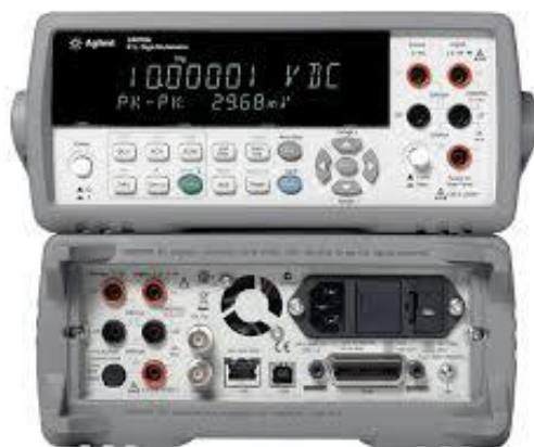
Figura 4.4 Fotografía del multímetro usado para las medidas eléctricas R vs T.
