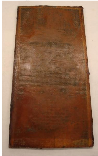
Figura 53 – Placa de resina fenólica con partículas mesoporosas de sílice reforzada con fibras de carbono.
