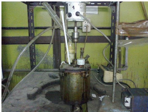
Figura 18 – Reactor utilizado con termómetro, sistema de refrigeración y agitador.
