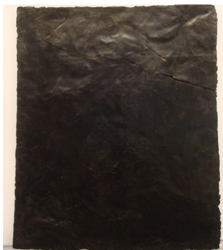
Figura 29 - Placa de resina fenólica con 20% en peso de negro de humo.
