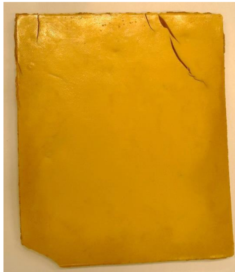
Figura 27 - Placa de resina fenólica con 20% en peso de partículas mesoporosas de sílice.
