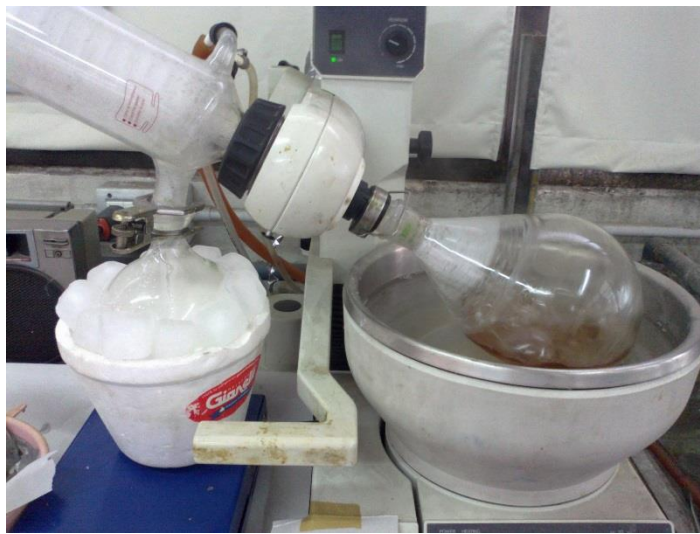
Figura 19 – Deshidratación de la resina en un rotavapor.
