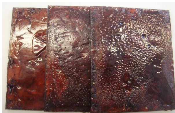
Figura 65 – Placas obtenidas con batches de resina fenólica de mala calidad.
