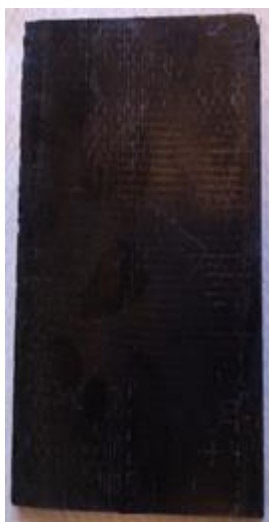
Figura 54 – Placa de resina fenólica con negro de humo reforzada con fibras de carbono.
