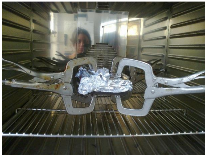
Figura 25 – Molde cerrado con pinzas dentro de la estufa.
