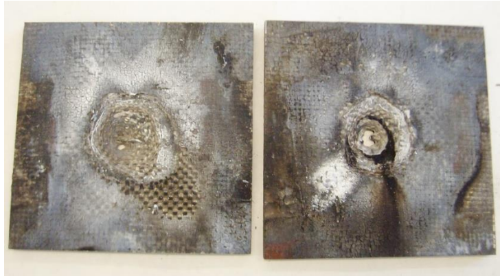
Figura 68 - Placas luego del ensayo de antorcha fallido.
