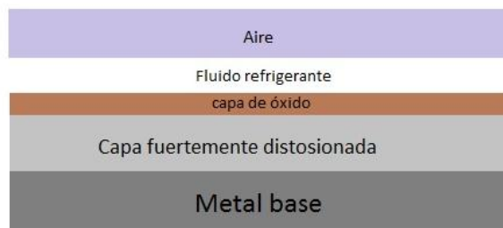
Figura 2.4.3. Interacción de las capas en la superficie de la pieza próxima a la zona de contacto.
