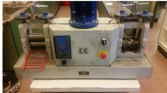
Figura 8. Trefiladora de laboratorio.
