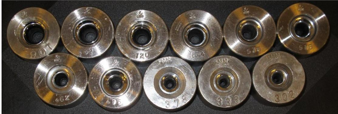
Figura 7. Trefilas de carburo de tungsteno (WC) utilizadas en el trabajo.
