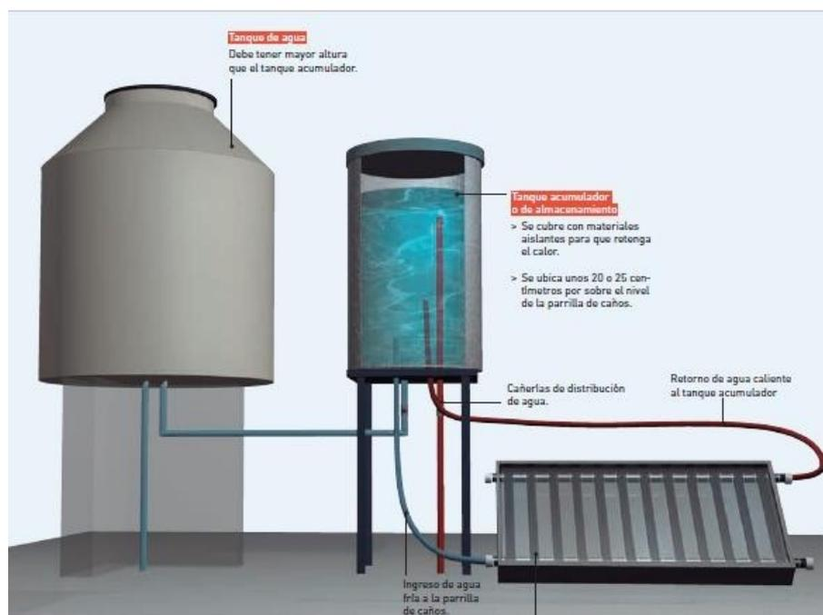
Figura 15. Instalación para la obtención de agua sanitaria por energía solar
