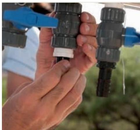
Figura 11 y 12. Llaves de paso, conectores y mangueras.
