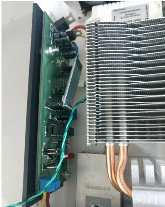
Capítulo 5, Figura 18 - Colocación de la placa con el circuito de entrada y el dsPIC
