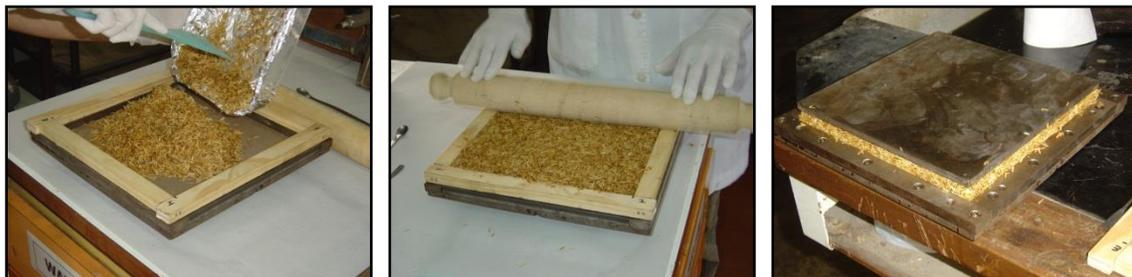
Figura 2.2 – Secuencia de preformado, previo al prensado.
