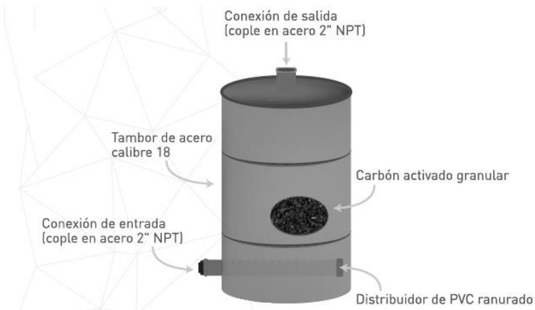
Figura 81. Tanque de Carbón activado.
