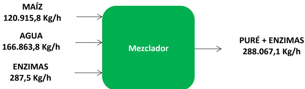
Figura 29. Corrientes de entrada y salida en mezclador.
