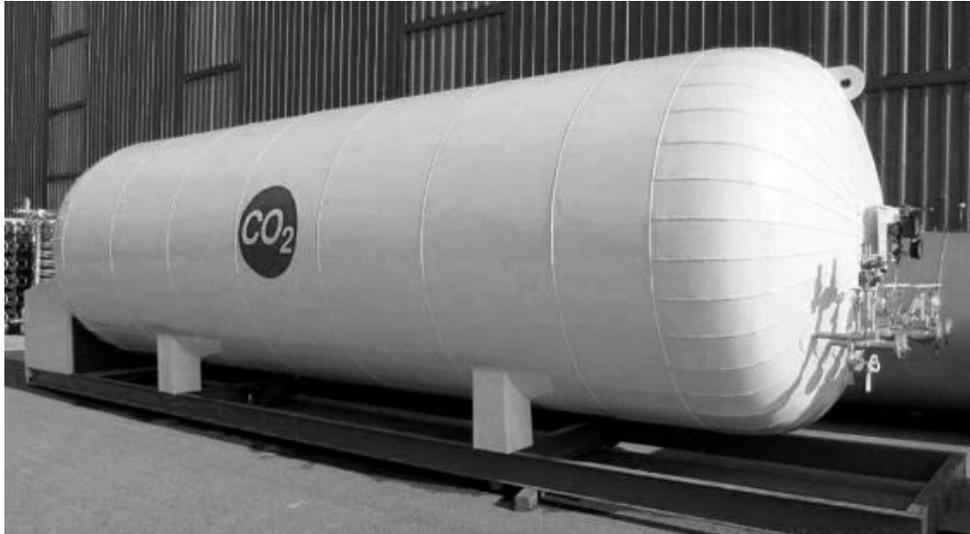
Figura 89. Tanques criogénicos para almacenar el CO<sub>2</sub>.
