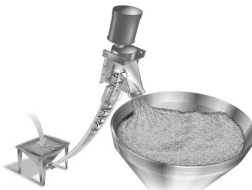
Figura 59. Esquema del transportador de tornillo flexible. (54)
