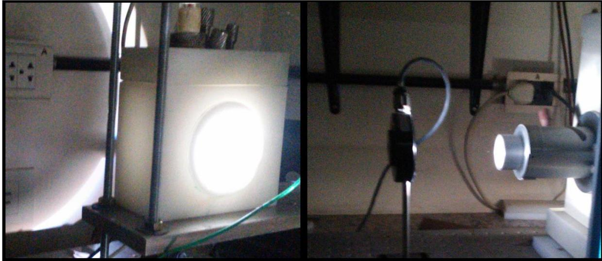
**Figura 5.16.** Fotografía del diseño experimental durante el ensayo de fotopotencial en la cual se puede apreciar a la izquierda la celda de trabajo bajo iluminación, y a la derecha la lámpara utilizada junto a su correspondiente obturador.
