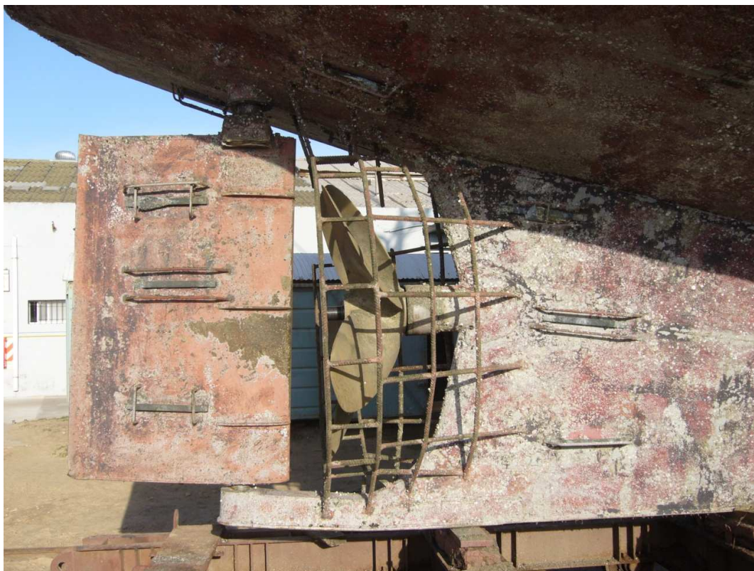
Figura 13: Estado del casco después del lavado
