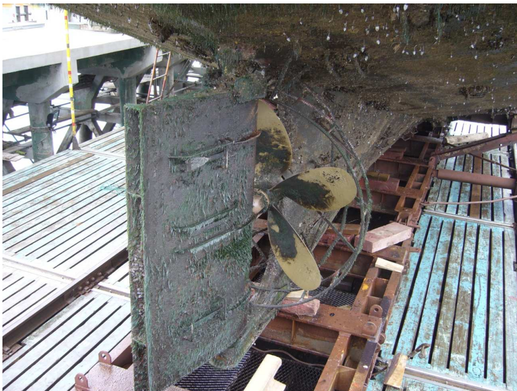
Figura 12: Estado del casco previo al lavado
