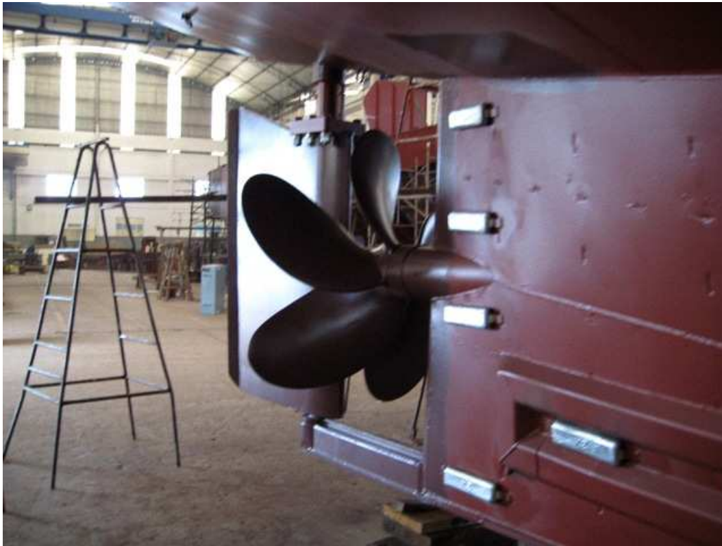
Figura 14: Protección catódica instalada
