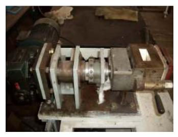
Figura 5. Mezclador tipo Brabender utilizado en el procedimiento 2.
