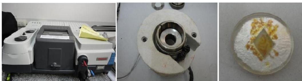
**Figura 13.** Equipo, horno y muestra utilizada en el ensayo de IR
