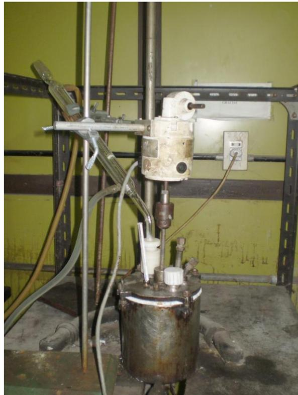
**Figura 15.** Reactor con agitador, termómetro y sistema de refrigeración.
