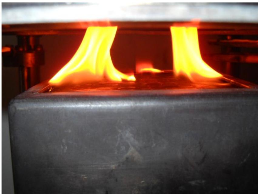
**Figura 38.** Ensayo de cono calorimétrico del material compuesto obtenido
