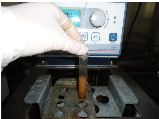
**Figura 12.** Medición de tiempo de gel de la resina
