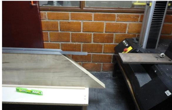
**Figura 30.** Dispositivo para realizar el ensayo de rigidez
