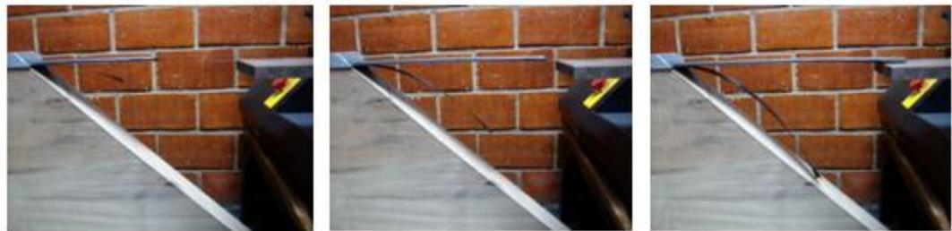
**Figura 31.** Secuencia del ensayo de rigidez de un prepeg
