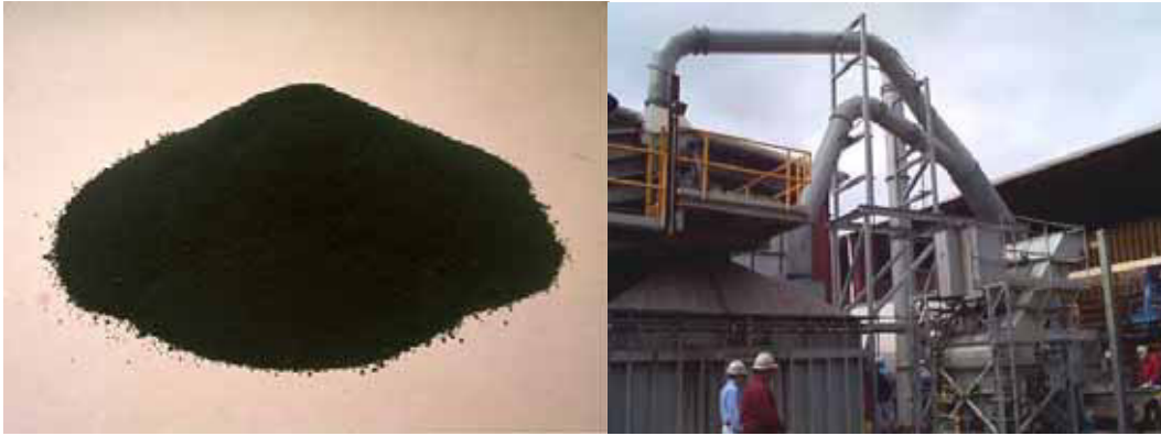
Figura 1.10: Aspecto de la ceniza de madera recibida y horno de quemado para la generación de energía.
