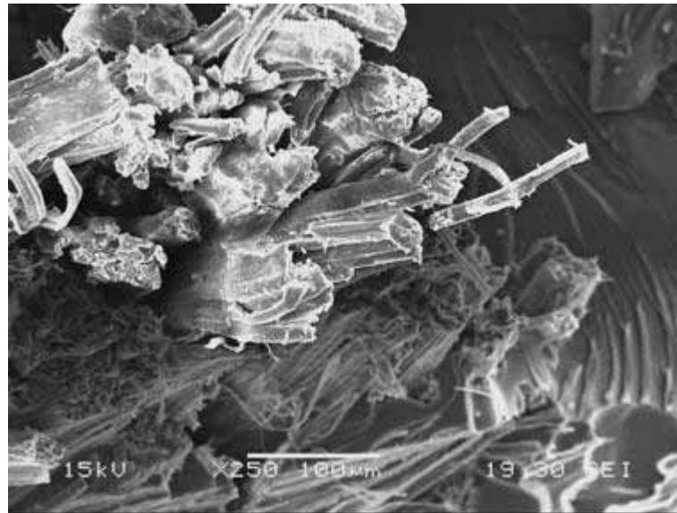
Figura 2.13: Micrográficas obtenidas por SEM de las superficies de fractura de las probetas ensayadas en tracción. (a) Compuesto con telas lavadas. (b) Compuesto con telas con tratamiento alcalino convencional. (c) Compuesto con telas acetiladas.. (d) Compuesto con telas con tratamiento alcalino bajo tensión 4 hs.
