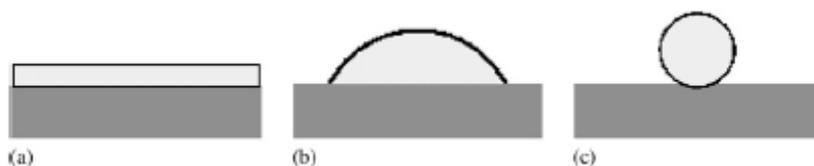
Figura 2.2.4. Un líquido en una superficie sólida puede tomar una de estas tres formas distintas: a) puede desparramarse formando una película uniforme ( $\theta=0^\circ$ ), b) puede formar un lente convexo con una sección menor que el radio de curvatura ( $30^\circ < \theta < 90^\circ$ ), o c) puede formar una sección mayor que el radio de curvatura ( $\theta > 90^\circ$ ).
