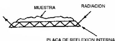
Figura 2.2.2. Técnica de reflexión o reflectancia total atenuada (Attenuated Total Reflectance, ATR).
