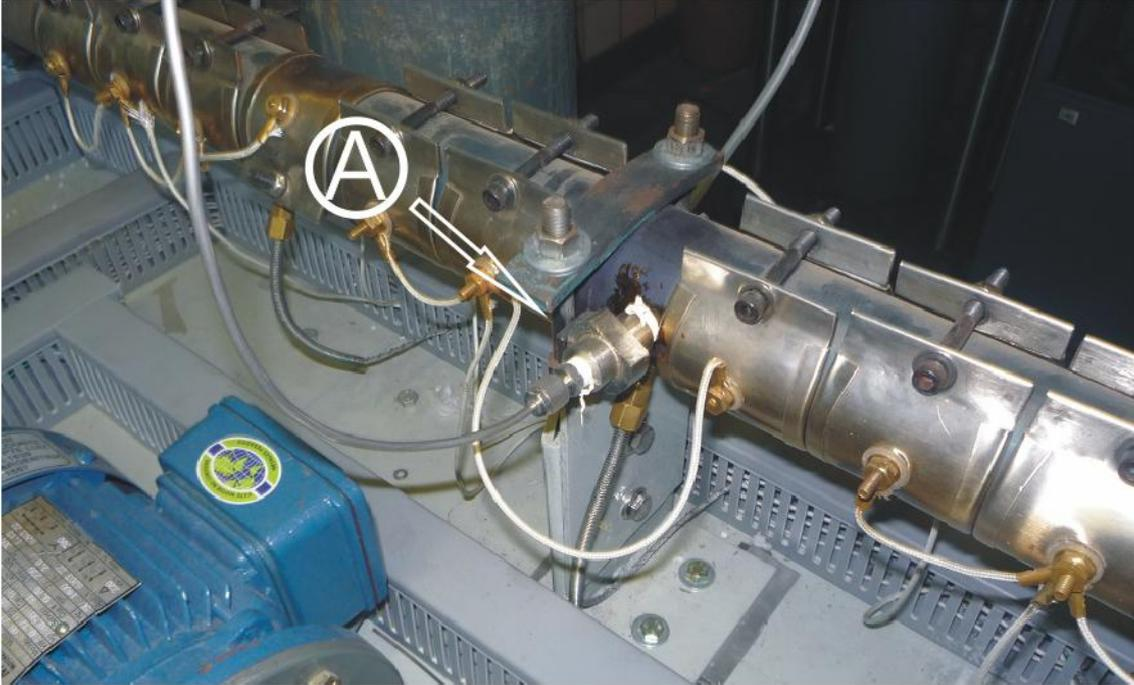
Imagen 2.5 – A. Válvula de no retorno para la inyección del agente de expansión.
