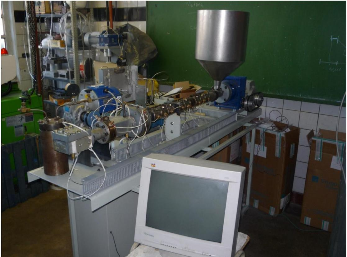
Imagen 2.1- Extrusora para procesamiento de espumas termoplásticas.
