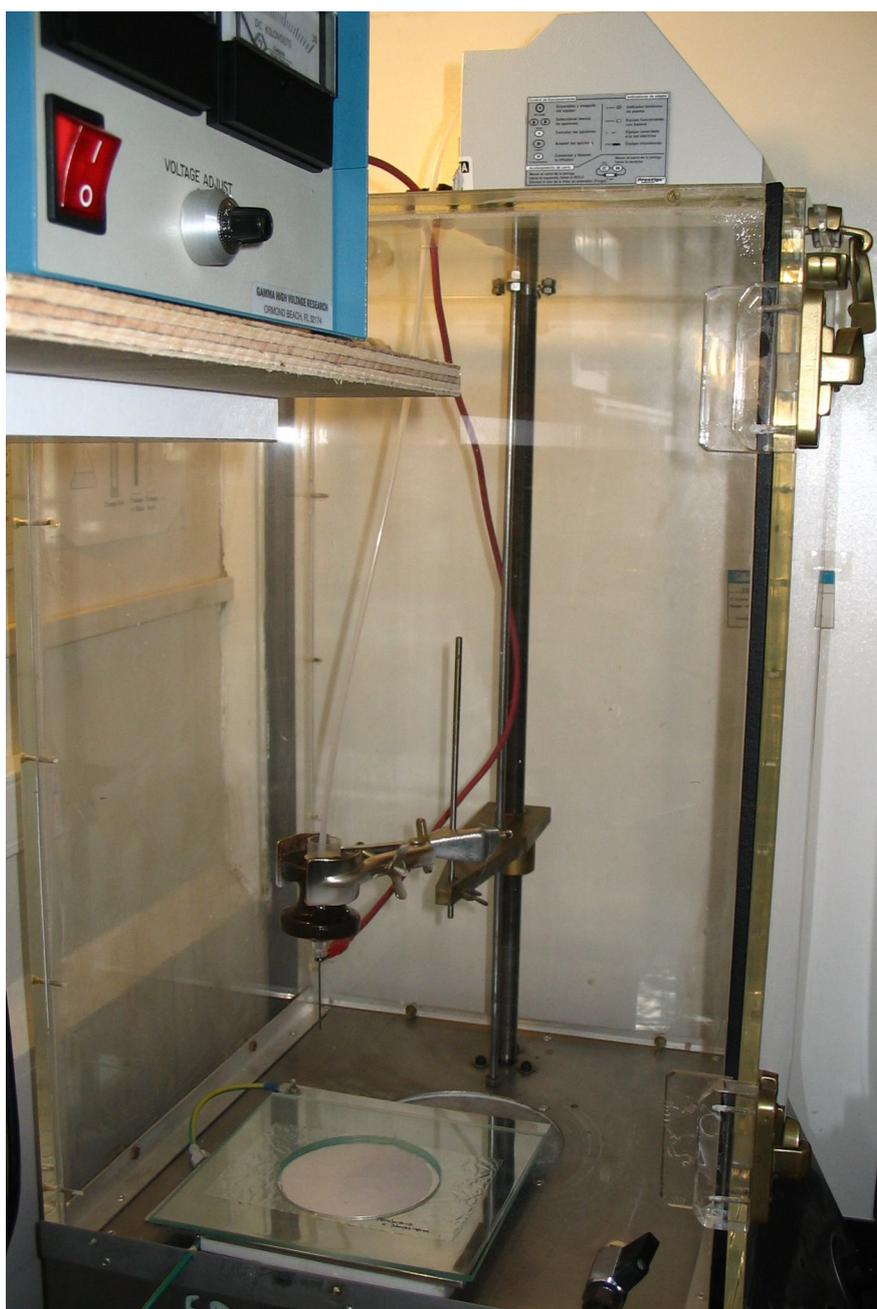
**Figura 13:** Fotografía del equipo de electrospinning empleado en este trabajo (Laboratorio de Polímeros Biomédicos, INTEMA)
