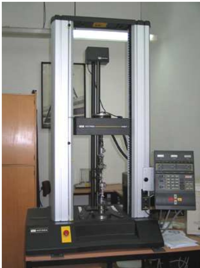
Figura 3.1: Máquina universal de ensayos INSTRON 4467
