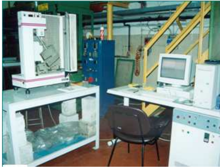
Figura 3.2: Equipo utilizado para el ensayo de Charpy instrumentado, conectado al ordenador.
