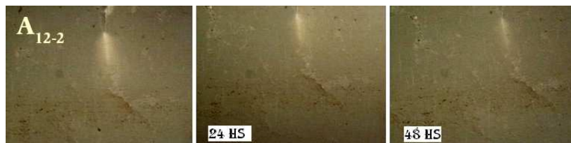
Figura 4.30: Evolución de la zona fresca en el material A_{12-2}
